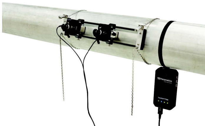
Messkopfhalterung, Ultraschallmessköpfe und PT900 werden am Rohr befestigt
